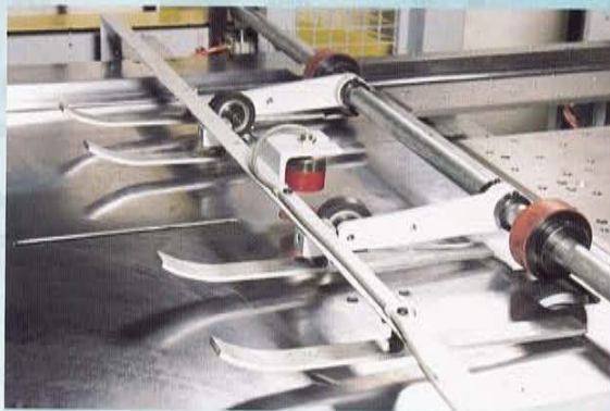
雙張鐵皮控制器與滾輪 Double sheet detector and rollers
