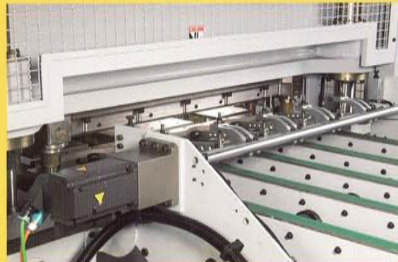
出口滾輪及輸送機 Discharge rollers and conveyor
