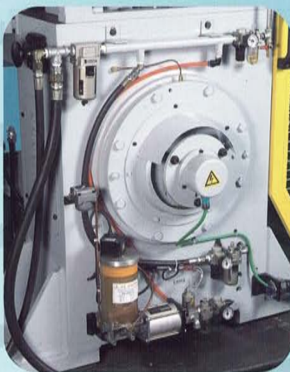
電子凸輪及自動黃油幫浦 Encoder and auto grease pump
